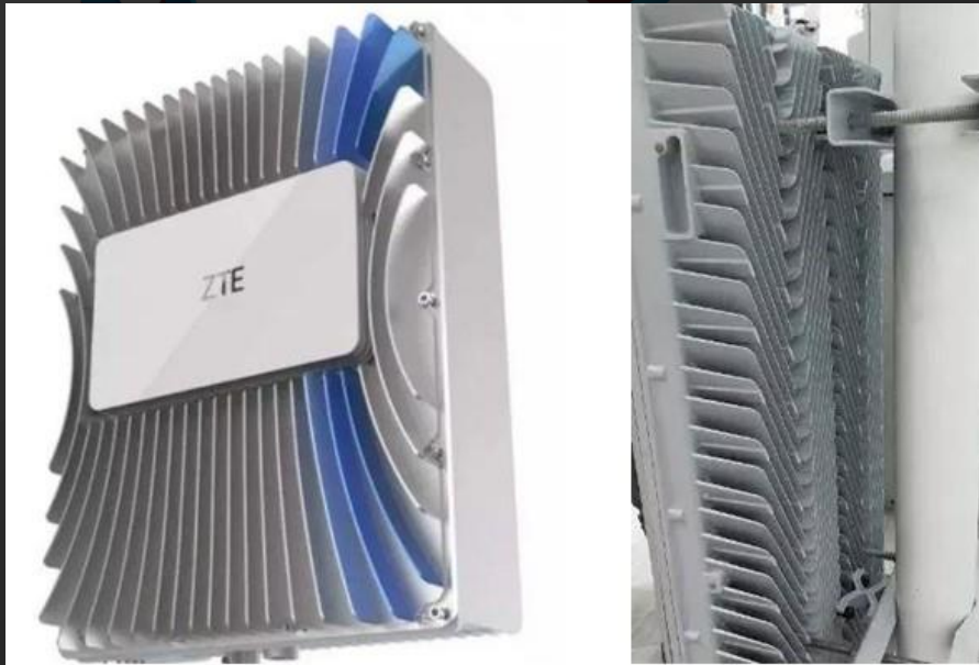
中兴通讯基站AAU设备采用 V型散热结构+液冷散热技术
